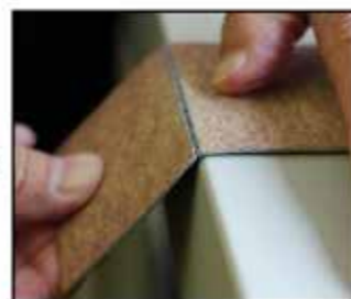
3. 机の角などに合わせて固定し上下に曲げる
